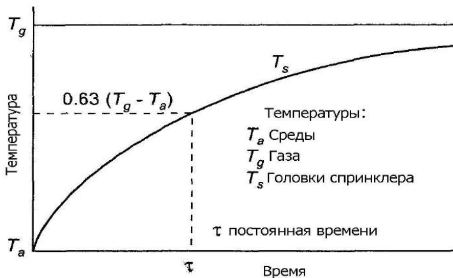
Рис. 14 Температуры в испытании погружением спринклера
