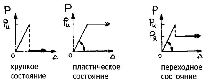
Рис. С.2. Идеализация реакции конструктивных элементов на перемещение нагрузки
